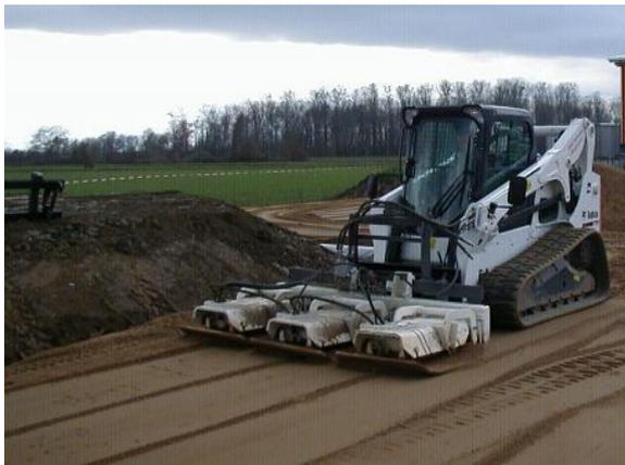
**Plattenanbauverdichter für Traktoren / Radlader**
