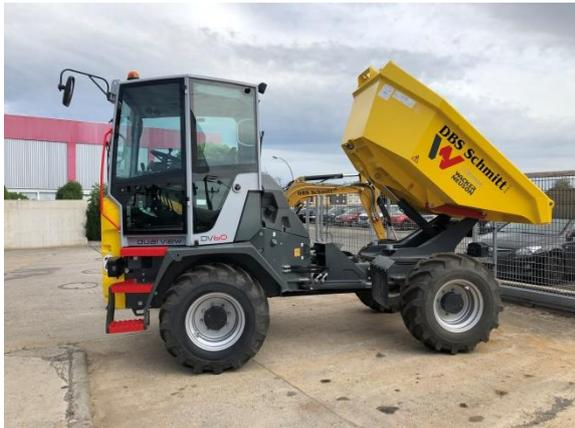
Raddumper-Führerhaus / Kippmulde-schwenkbar / 3,60m<sup>3</sup>
