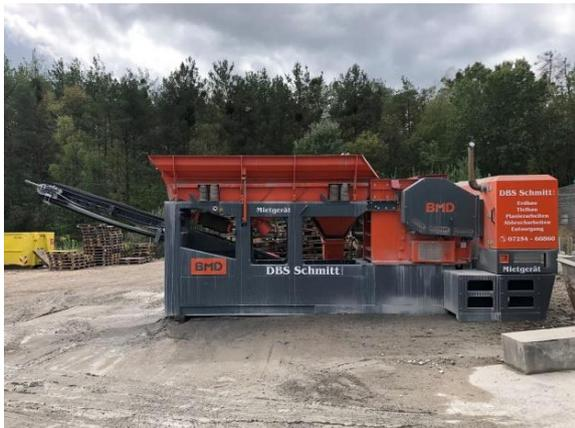
**BMD Backenbrecher / Containermobil / Leistung pro Stunde 40,00 to / Einsatzgewicht 15,00 to.**
