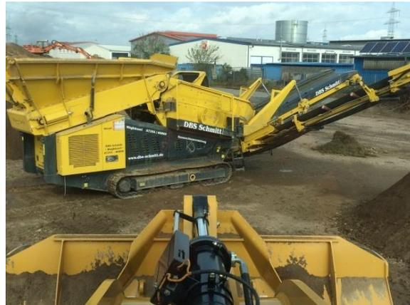
**Keestrack / 2 Deck-Siebanlage / Kettenmobil / auch für groben Bauschutz geeignet**
