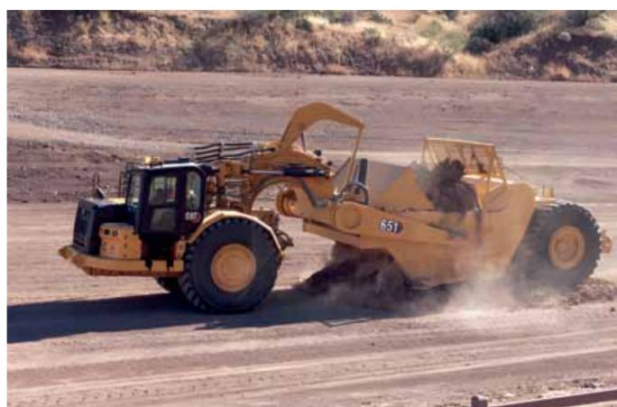
Der neue einmotorige Scraper Cat 651, meist in Flotten für lange, ebene Transportstrecken von 200 bis 2 500 Metern Länge eingesetzt, kommt mit einem Fassungsvermögen im Schürfkübel von 33,6 Kubikmetern gehäuft und einer Nutzlast von 46,4 Tonnen. Foto: Caterpillar/Zeppelin
